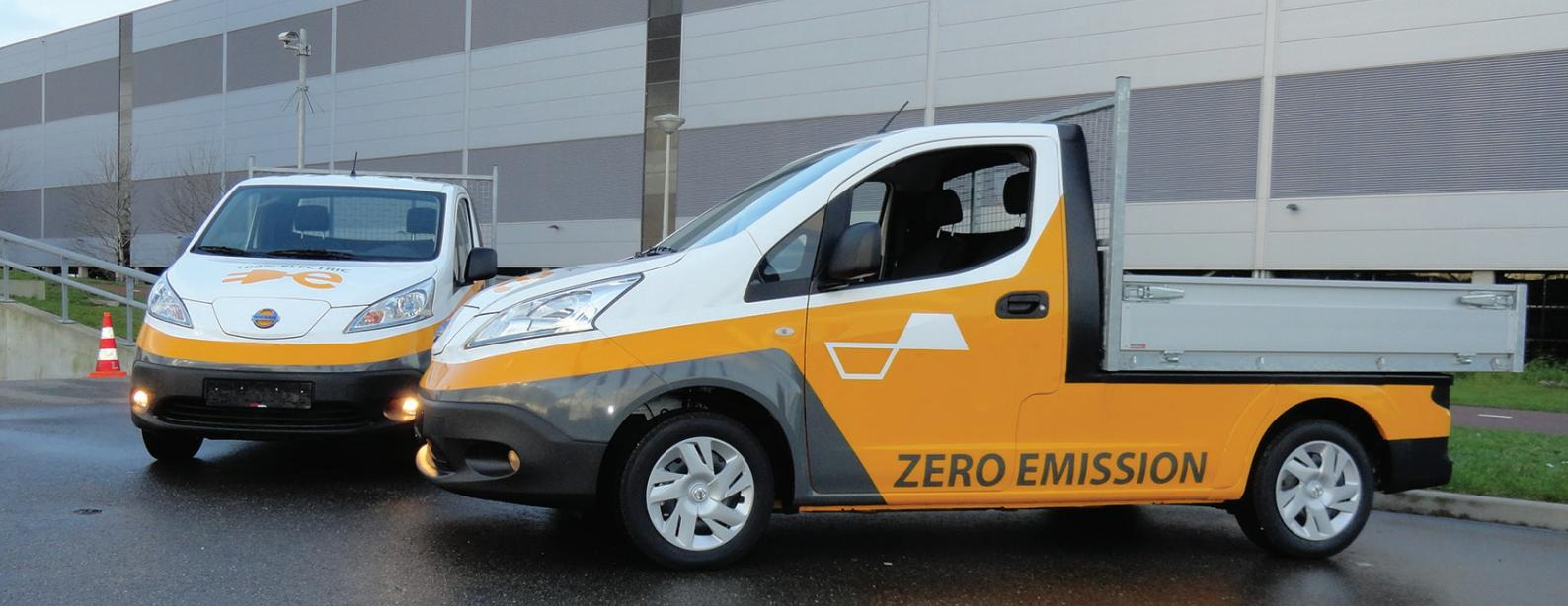
Veth Automotive biedt de mogelijkheid om de 100% elektrische Nissan e-NV200 aan te passen naar een pick-up uitvoering. Door de compacte afmetingen en de praktische laadbak is de e-nv200 een ideale auto voor bijvoorbeeld hoveniers, gemeenten en reinigingsdiensten.
